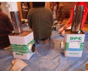
災害時・非常時に役立つロケットストーブ。材料は一斗缶、ストーブの煙突、断熱材。
